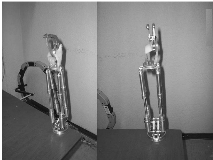
Fig. 5. Prototipo de mecanismo paralelo para aplicación de prótesis
