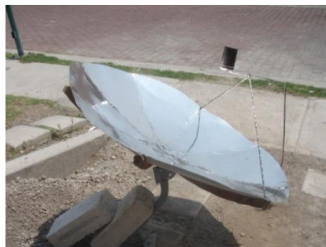
Fig. 6. Colector Solar Parabólico.
