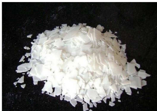
Fig. 6. Activador alcalino (hidróxido de sodio) en presentación de escamas.
