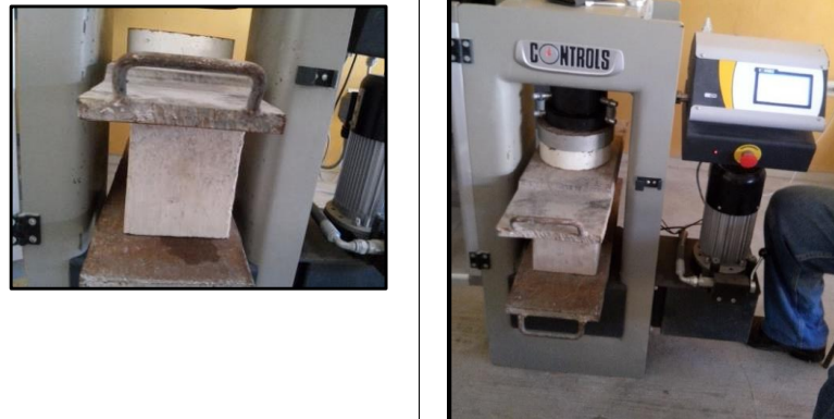
Fig. 9. Ensayo de resistencia a la compresión.
