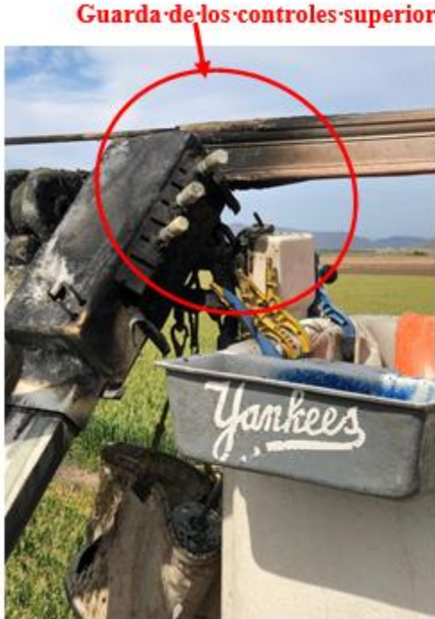
Figura 3 Estado de la caja de controles.
