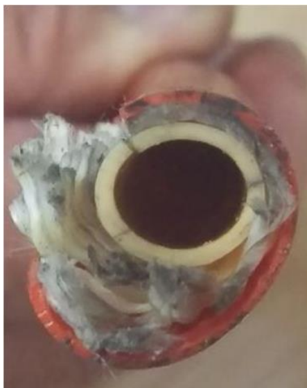
Figura 8, Manguera naranja, compuesta de 3 elementos, el recubrimiento plástico, la malla de nylon y el núcleo.
