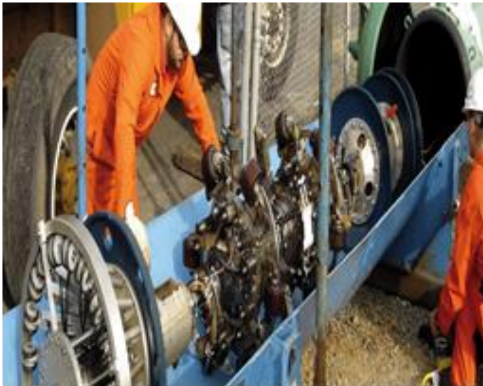
Fig. 29. Inspección interior con equipo instrumentado [26]
