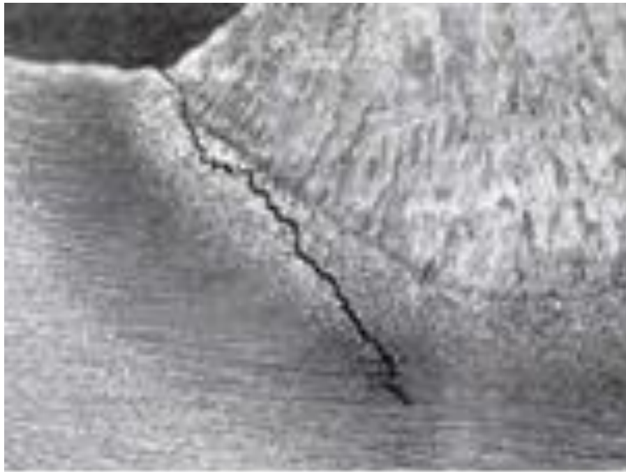
Fig. 14. Fisura en soldadura [16]
