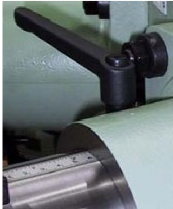
Figura 18. Husillo estándar para máquina de transferencia rotativa de corte viruta.
