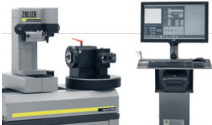
Figura 16. Equipo de ajuste y medición horizontal por visión.
