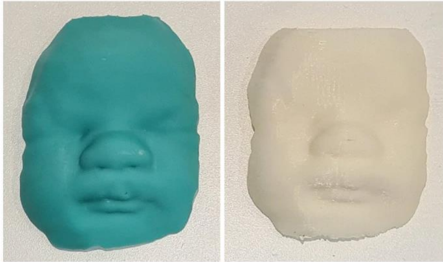
Fig. 2. Comparación de impresión 3D en LCD, izquierda y FDM, derecha (Werner, Tonni y Lopes, 2023).
